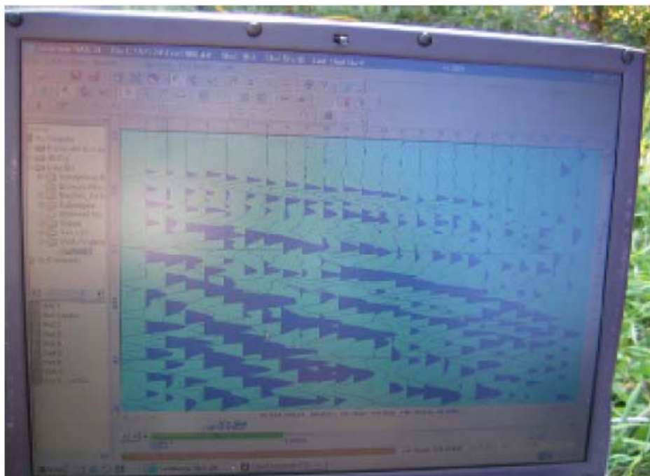
Sl. 43. Seizmometrijsko mjerenje refrakcije na brdu Toprakalia, Gornja Vratnica. Institut za geofiziku, Rudarsko-Geološki fakultet Beograd, Srbija Fotografija display-a na snimanju 11. oktobra 2006 (Photo: prof. dr Muris Osmanagić)
