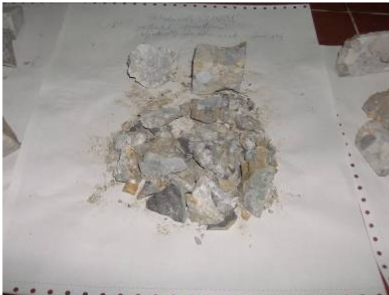
Fotografija 3. Izgled razrušenih probnih kocki građevinskog materijala prekrivnog sloja Bosanske piramide Sunca (Visoko) poslije ispitivanja pritiskne čvrstoće
